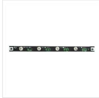
Die VM7404 4-Port 3G-SDI Eingabekarte bietet eine einfache Möglichkeit der Weiterleitung von 4 SDI Video und Audioquellen an mehrere Anzeigen, wenn sie in Kombination mit ATEN Modular Matrix Switch verwendet wird.
