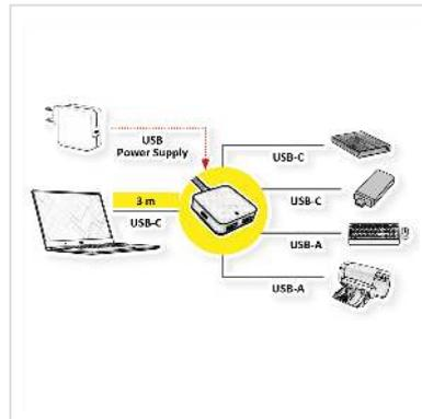
**Der handliche Hub mit 3 m langem USB-Anschlusskabel ermöglicht den Anschluss von bis zu vier USB Peripheriegeräten in größerer Entfernung vom PC. Damit ist der Anwender vom Standort der anzuschließenden Geräte (z.B. Drucker) fast unabhängig.**
