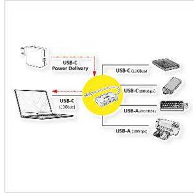
**Mit diesem handlichen ROLINE USB 3.1 / USB 3.2 Gen 2 Hub mit USB-Typ-C Anschlusskabel können Sie problemlos bis zu vier USB-Geräte (2x USB A + 2x USB C) mit einer Übertragungsgeschwindigkeit von jeweils bis zu 10 Gbit/s anschließen. Außerdem wird PD (Power Delivery) mit bis zu 100W zum Aufladen Ihres Geräts unterstützt.**
