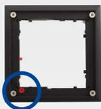
Der FlatMount Frame verfügt über einen elektromagnetischen Diebstahlschutz, der das Herauslösen des Moduls verhindert. Achten Sie darauf, dass der Pfeil auf dem roten Drehknopf (Diebstahlschutz) auf das Symbol „offenes Schloss“ zeigt und der Rahmen so eingesetzt wird, dass sich der rote Drehknopf links unten befindet.
